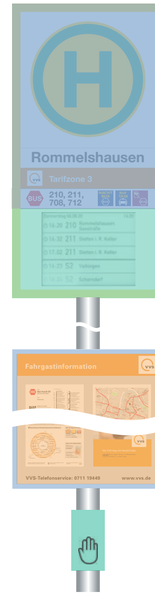
Haltestellenmast mit Haltestellenschild und DFI-Light-Modul mit optionalem TTS-Taster für Vorlesefunktion (Text to Speech)
